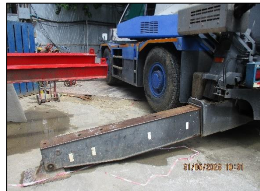
รูปที่ 80 วัสดุป้องกันการล้มสะเทือนรองไว้ใต้เครื่องจักร
