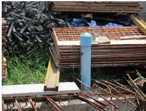
รูปที่ 32 ติดตั้งเครื่องมือตรวจวัดการเคลื่อนตัวของดิน
