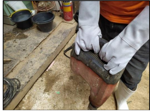
รูปที่ 81 วัสดุป้องกันและดูดซับการสั่นสะเทือนหุ้มด้ามเครื่องมือ
